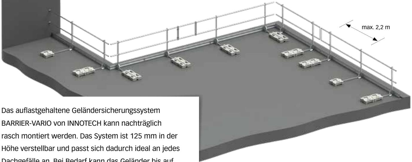
Das auflastgehaltene Geländersicherungssystem BARRIER-VARIO von INNOTECH kann nachträglich rasch montiert werden. Das System ist 125 mm in der Höhe verstellbar und passt sich dadurch ideal an jedes Dachgefälle an. Bei Bedarf kann das Geländer bis auf 75° geneigt oder umgeklappt werden, wodurch sich das System hervorragend in die bauliche Gegebenheit einfügt.
