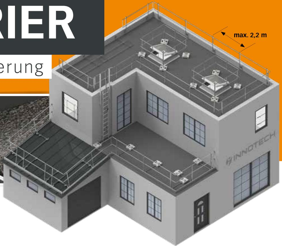
Die optimierte Geländersicherung BARRIER von INNOTECH bietet viele unterschiedliche Einsatzmöglichkeiten im kollektiven Seitenschutz, da es sich optimal an individuelle bauliche Gegebenheiten anpasst. Durch die konsequente Optimierung der Einzelkomponenten konnte die Funktionalität verbessert und die Montagezeit deutlich reduziert werden. Der unkomplizierte, rasche
