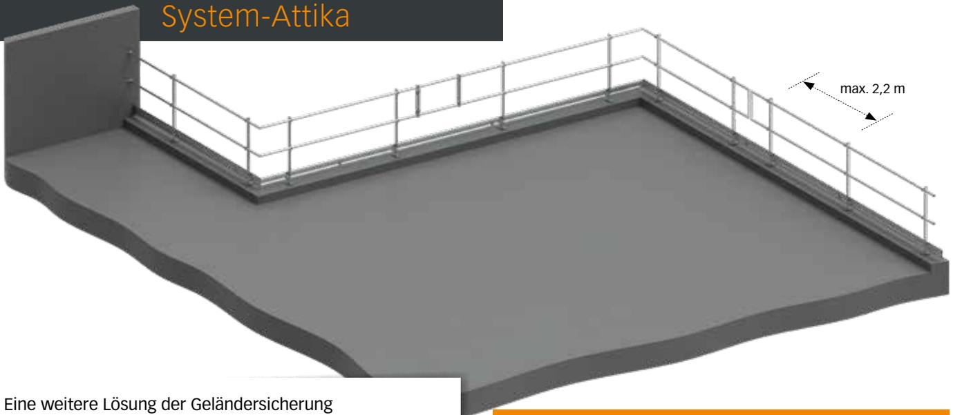
Eine weitere Lösung der Geländersicherung BARRIER von INNOTECH besteht in der Montage auf Attika-Untergrund. Die Geländersicherung kann entweder auf die Attika oder alternativ an der Innenseite der Attika befestigt werden. Das System ist im Neigungswinkel (90°, 75°, 60°) bequem verstellbar. Um die Ästhetik des Gebäudes beizubehalten, besteht die Möglichkeit das System vollständig umzuklappen.
