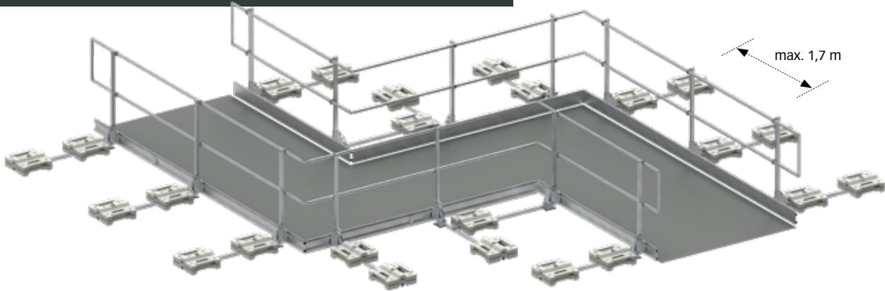
Das Fluchtweg SYSTEM-VARIO von INNOTECH wird auflastgehalten und somit dachdurchdringungsfrei montiert. Das flexible System ist variabel in der Breite verstellbar, benötigt aufgrund der großen Feldabstände deutlich weniger Material und verringert somit die Auflast.
